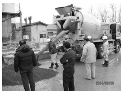
図1 生コンクリートプラントでのIWA骨材の製造
