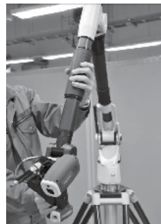
図1 アーム型三次元測定器（ニコンMCAx25+）、非接触式プローブ（ニコンMMDx100、左下の装置）
