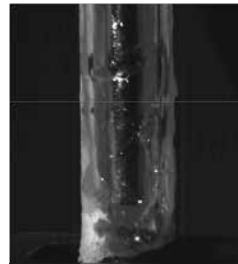
図6 可視化観測結果 外管流速, 0.75 m/s
