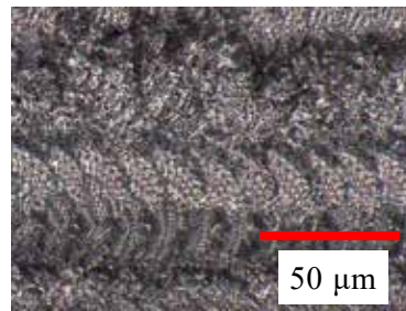
Sa : 9.278 μm 残留応力(圧縮): 689.4 MPa (c) UVM 10 μm p-p
