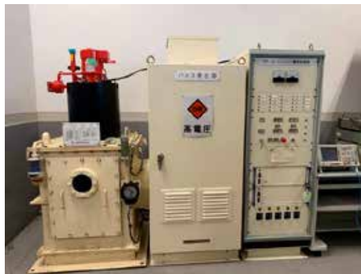
図1 クライストロンと駆動用高圧電源
