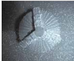
図1 タフト法による可視化 (主軸回転数 n=5000\text{min}^{-1} )
