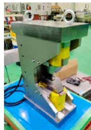
図3. 製作した電磁石
