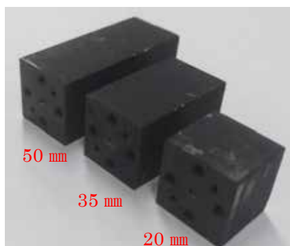
図1 試作したWR-15ミリ波導波管
