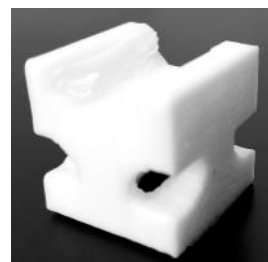
図2 トポロジー最適化レンズ (主ビームのビーム幅の狭角化)
