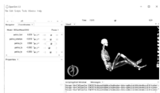
図3 筋骨格モデルによる自転車の解析
