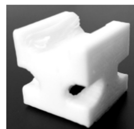
図2 トポロジー最適化レンズ (主ビームのビーム幅の狭角化)
