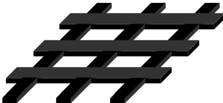
図. 次世代透明導電膜に期待される格子状金属薄膜細線
