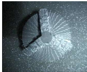
図 1 ヶト法による可視化 (主軸回転数 n=5000^{-1} )
